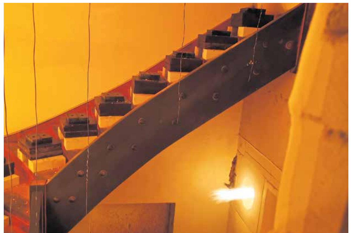
Abbrandversuch bei der Gesellschaft für Materialforschung und Prüfanzstalt für das Bauwesen (MFPA) in Leipzig: Um die Feuerwiderstandsklasse F30 zu erreichen, muss die Holztreppe 30 Minuten lang den Flammen standhalten.
